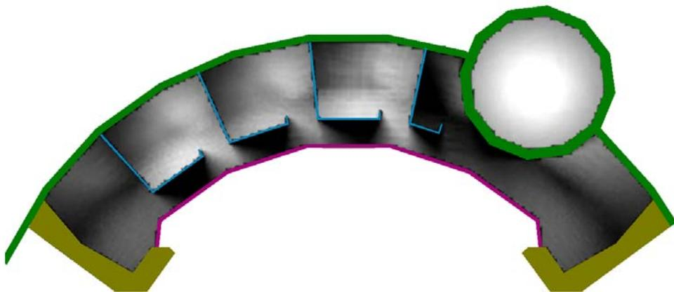
FIG\_4.- Mapa de factor de cielo en la planta alta del Hemiciclo Solar. Valores en gradación continua hasta 2%.
