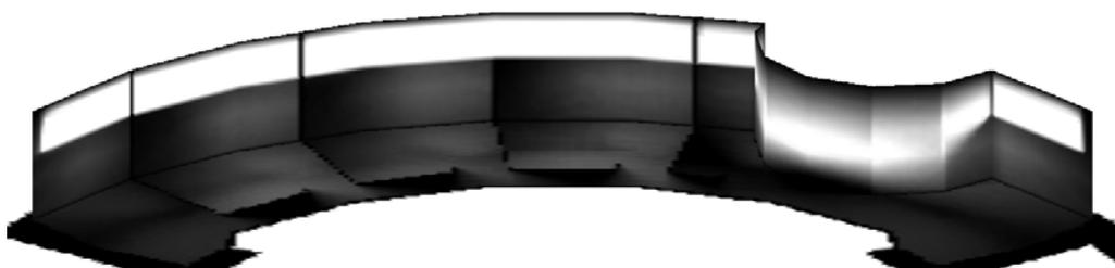
FIG\_5.- Mapa de factor de cielo en la planta alta del Hemiciclo Solar. Valores en gradación continua hasta 5%.
