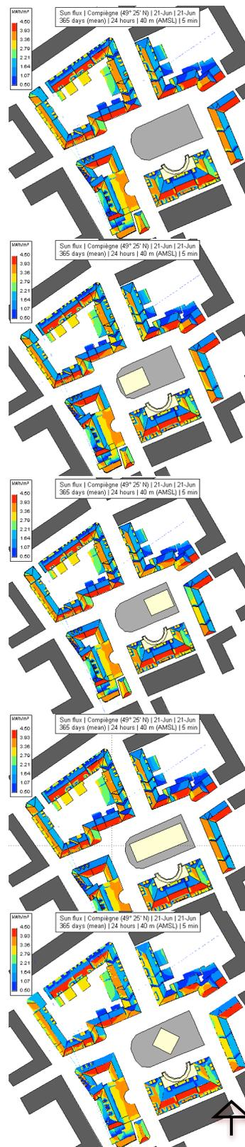
Cálculo de flujo solar recibido en techos durante el periodo anual. Suma de calculo de todos los techos. Suma de tres techos mas afectados para disminuir rango sumatorio y análisis sobre un techo específico.
