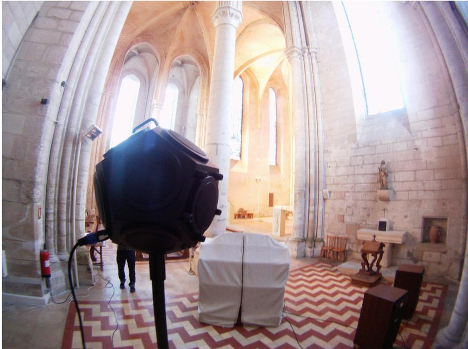
Figure 12 : Source omnidirectionnelle positionnée à 2 mètres du sol dans le transept, côté sacristie.
