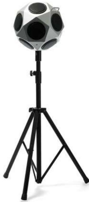
*Figure 14 : Haut-parleur dodécaédrique OmniPower de Type 4292-L par Brüel & Kjær.*
