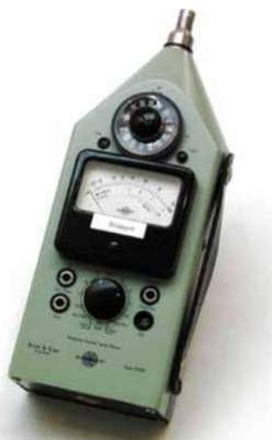
Figure 12 : Premier sonomètre portable 2203 par Brüel & Kjaer en 1960 (Aflalo, 2005).
