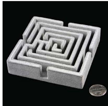
*Modelo tridimensional de un laberinto construido por una impresora tridimensional*
